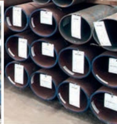
Desde  $\varnothing$  33,70 mm. a  $\varnothing$  863,00 mm. en espesores desde 3 mm. a 100 mm.
